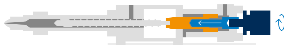
Osvědčená in-line vstřikovací jednotka a inovativní APC zajišťují extrémně dobrou konstantní hmotnost dávek.
